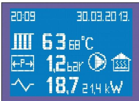
En appuyant sur le bouton OK dans le menu, l'affichage change afin que les paramètres réglés en mode préparation d'eau sanitaire puissent être vérifiés
