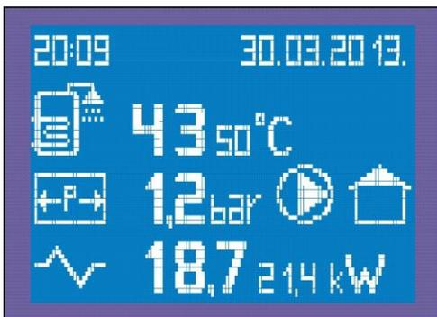
Si l'appareil est en mode préparation d'eau sanitaire, en appuyant sur le bouton OK les paramètres réglés et les paramètres du système de chauffage peuvent être vérifiés
