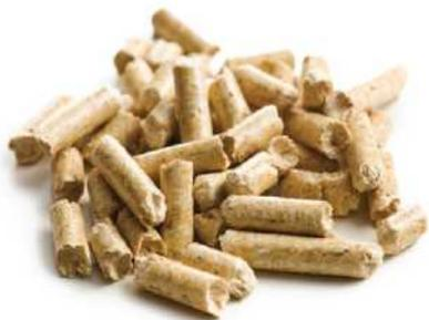
Les granulés de bois sont des petits bâtonnets de bois compacté et sont principalement obtenus à partir de troncs d'arbres ou de déchets de sciage et de rabotage. Les granulés de bois de haute qualité se remarquent avec leur éclat soyeux mat, leur grande résistance et à leur faible teneur en poussière. Les bons granulés de bois ne présentent pas de stries longitudinales.
