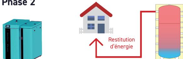
Enfin, l'énergie est restituée au chauffage et à l'eau chaude sanitaire quand la chaudière est arrêtée.
